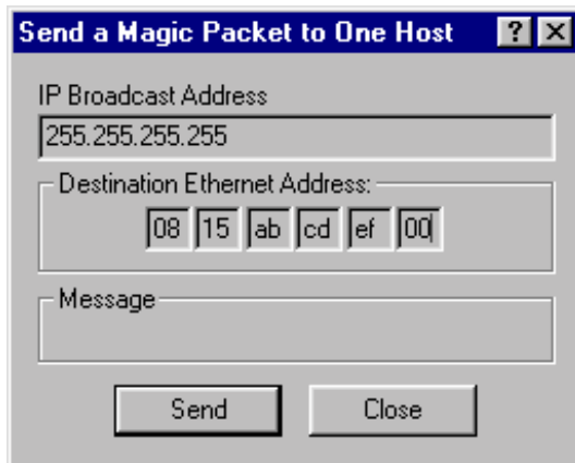
Abb. 10: Identifizierung des Zielrechners über die MAC-Adresse.
