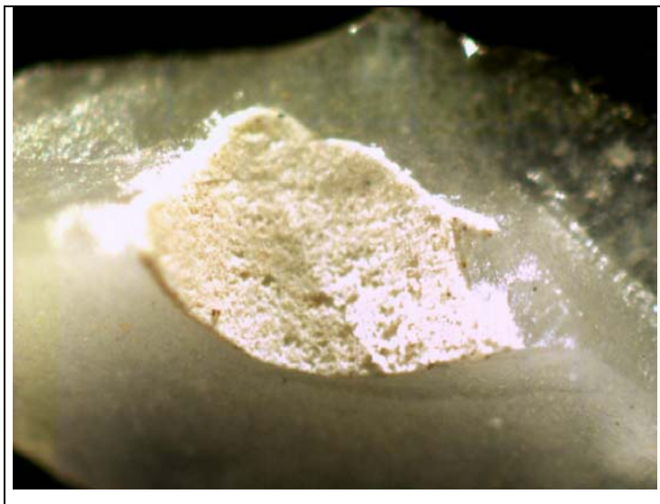
Tafel 2.2: Aufnahme eines der dislozierten Bruchstücke der Probe aus Tafel 2.1. Auf der Innenfläche des Keramiksplitters befinden sich Reste des aufgetragenen Opakers; nur vereinzelt stellen sich wenige Goldpartikel, welche sich von der Oberfläche des Galvanokäppchens gelöst haben könnten, dar.
