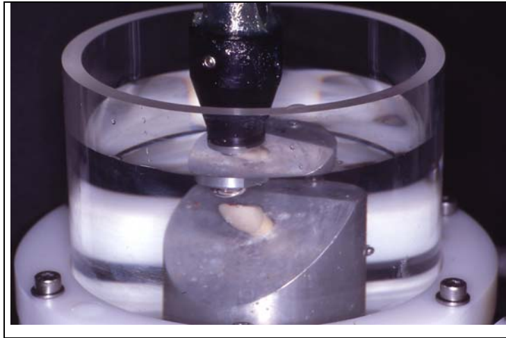
Tafel 1.3: Mit destilliertem Wasser geflutete Kammer zur Simulation des Feuchtmilieus der Mundhöhle. Die Wasserspiegelhöhe wurde bis über den oberen Rand der Vorrichtung zur Befestigung des Antagonisten gestellt.
