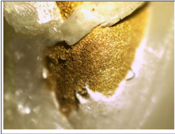
Tafel 2.1: Makroskopische Detailaufnahme einer bis aufs Metall gebrochenen Probe (Bruchtiefe ,m') der Gruppe O. Die raue Oberflächenstruktur des Galvanokäppchens stellt sich dar.
