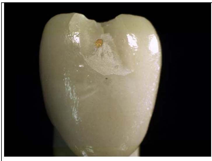
Tafel 2.4: Detailaufnahme einer Probe aus Gruppe B als Beispiel für einen Adäsivbruch (Bruchtiefe ,m'). Die Oberfläche des Galvanokäppchens ist bukkoinzisal punktuell sichtbar.
