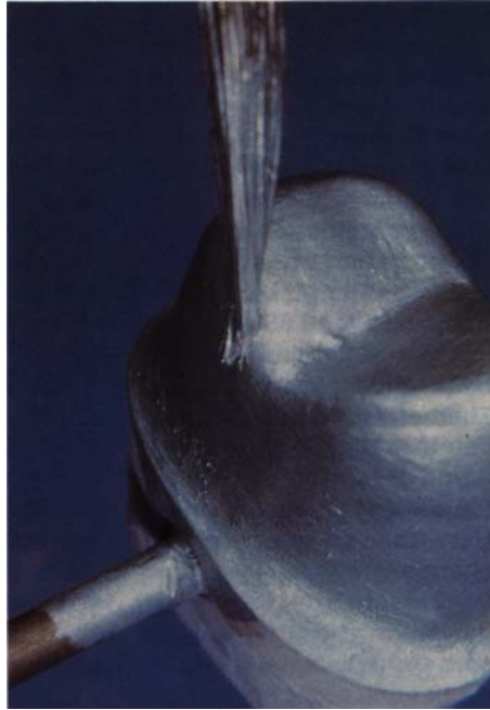
Abbildung 3: Zeigt am Beispiel eines Prämolarenmodells mit angebrachtem Kupferdraht das Auftragen des Silberleitlacks.
