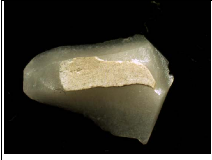
Tafel 2.7: Disloziertes Bruchstück der Probe aus 2.6 der Gruppe B. Auf der Innenfläche stellen sich flächig Reste des Opakers ‚weißlich‘ dar. Auf Grund der Beschaffenheit der aufgebrannten Keramik lässt sich die Keramik von der aufgetragenen Opakerschicht unterscheiden, jedoch lassen sich keine sichtbaren Reste der Bonderschicht auf diesem Bruchstück finden.
