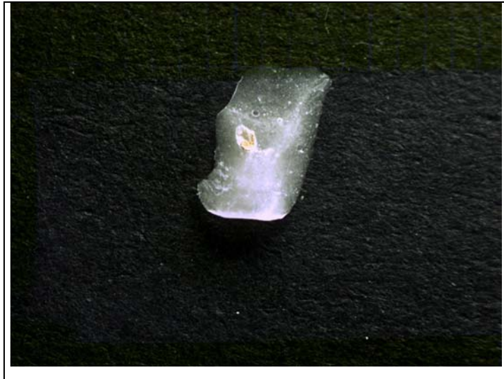
Tafel 2.5: Korrespondierendes disloziertes Bruchstück zur Probe aus Tafel 2.4. Auf der Innenfläche des Keramiksplitters sind Opaker- und vermutlich ‚Goldreste‘ sichtbar. Der makroskopischen Aufnahme ist nicht eindeutig die Herkunft der ‚Goldreste‘ zu entnehmen.
