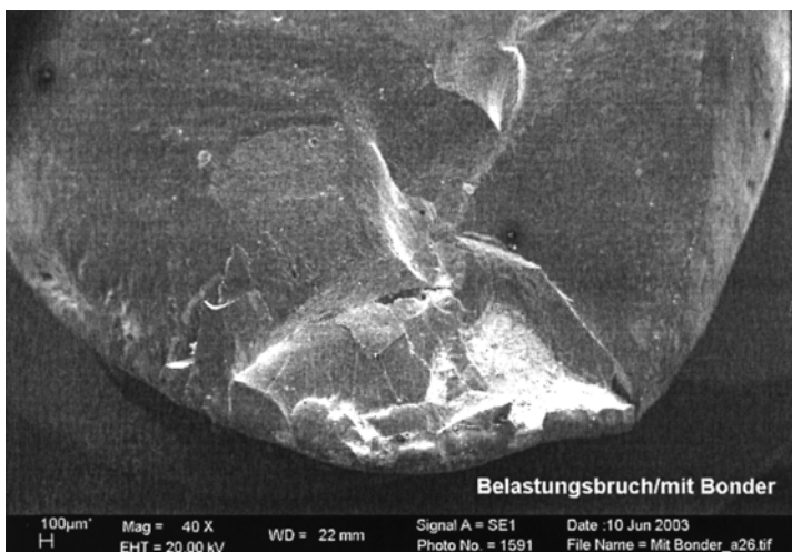
Abbildung 19: Darstellung der Bruchfläche der Probe aus Abbildung 18.
