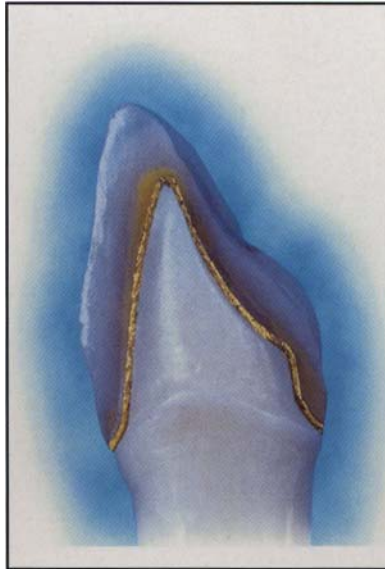
Abbildung 5: Schnitt durch einen Prüfkörper. Darstellung der gleichmäßigen Schichtdicke eines Galvanokäppchens.
