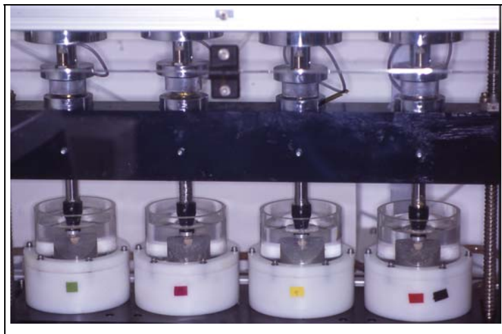
Tafel 1.4: Darstellung des ‚arbeitenden‘ Kausimulators. Im oberen Bildteil ist der Balken sichtbar, an welchem die Gewichte angebracht sind, die über die Gewindevorrichtung die Kraft über einen Stempel an jede Probe übertragen. Direkt oberhalb des schwarzen Querbalkens in der Mitte des Bildes befindet sich die Schraubvorrichtung für jede einzelne Kammer, anhand welcher die Höhe der Steatitkugel manuell feinjustiert werden konnte. Die Plexigalsbehälter dienen als Begrenzung jeder der 8 Kammern und können mit beliebigen Flüssigkeiten geflutet werden.
