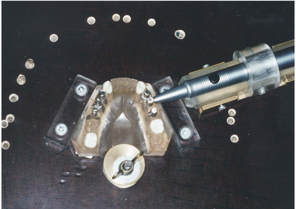
Bild 2. Modell und Periotesthandstück bei der Messung
