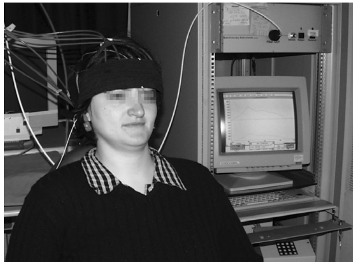
Abbildung 4-6: Probandin mit angebrachten NIRS-Optoden. Ein schwarzes elastisches Band diente sowohl zur Fixierung als auch zur Reduktion von Streulicht. Daneben ist das NIRS-Gerät abgebildet. Oben ist die Halogen-Lichtquelle zu sehen. Darunter der Computer zur Spektralanalyse.
