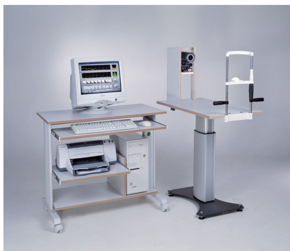
Ab. 5: Messeinrichtung Pupillographischer Schläfrigkeitstest (PST, Hersteller Fa AMTech, Weinheim)
