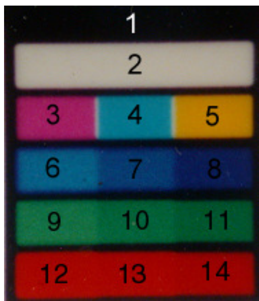
Abbildung 9: Testbild zur Bestimmung der Farbwiedergabe mit Nummerierung der Farbregionen
