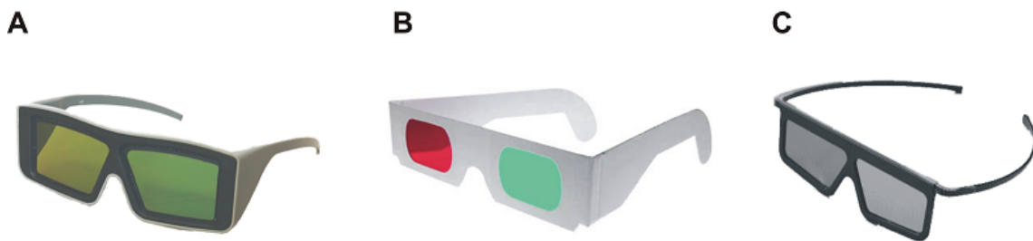
Abbildung 2.28: Bei einer 3D-Projektion wird pro Auge jeweils ein Halbbild gleichzeitig oder kurz nacheinander präsentiert. Je nach Visualisierungstechnik filtern unterschiedliche 3D-Brillen die Bilder für das linke und das rechte Auge. A) In die Gläser einer Shutterbrille sind LCDs eingebaut, die sich über Steuersignale verdunkeln lassen und somit nur für spezifische Halbbilder durchlässig sind. B) Bei einer Farbfilterbrille löschen die Brillengläser jeweils ein Halbbild der entsprechenden Farbe aus, während das andere Bild in der Komplementärfarbe schwarz wahrgenommen wird. C) Die Polfilterbrille lässt aufgrund der 90^\circ zueinander gedrehten Polarisationsfilter nur bestimmte Halbbilder je Auge passieren.
