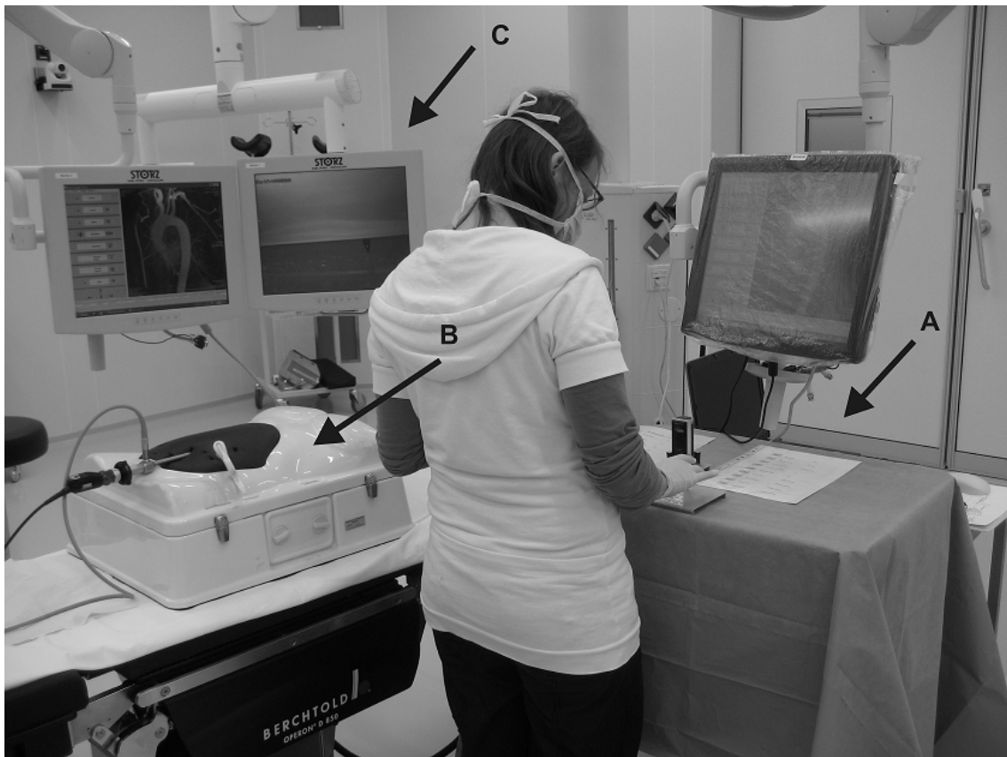
Abbildung 4.15: Versuchsaufbau im OP. A) Der Computer-Arbeitsplatz mit dem jeweils zu testenden Eingabegerät und der Hilfedokumentation. B) Laparoskopie-Trainer. C) Monitore für die Endoskop-Kamera (r.) und für ein zusätzliches Bild des Viewers (l.).
