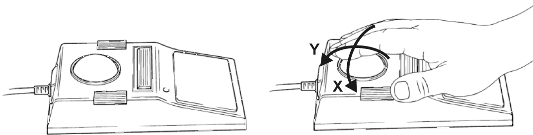
Abbildung 2.22: Darstellung des Trackball, nach VDI/VDE 3850-2 [VDI02, S. 19]. Bewegungen der Rollkugel entlang der X- und Y-Achse werden in zweidimensionale Zeigebewegungen auf dem Bildschirm übersetzt.
