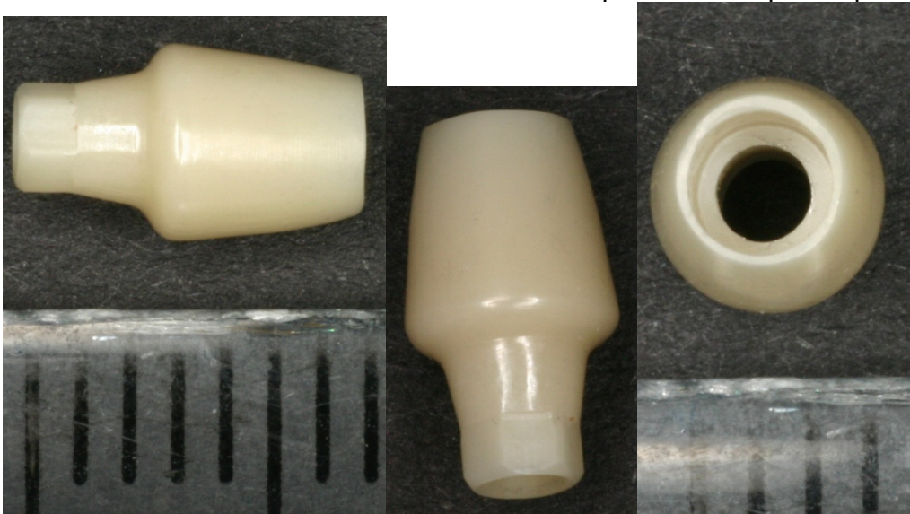
Abb. 7: Detailaufnahme des vollkeramischen optimierten Implantatpfostens
