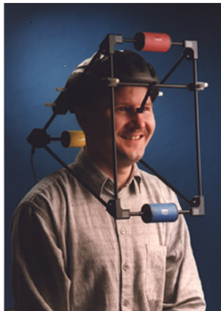
Abbildung 2: Proband mit Messhelm einschließlich Carbongestänge und Senderspulen
