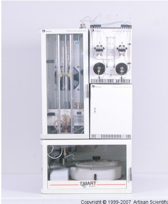
Abb. 39 zeigt das SMART® System als HPLC- Anlage zur Trennung von Stoffgemischen (Bild der Herstellerfirma Artisan Scientific)
